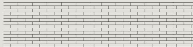
Parkett, bestehend aus Elementen gleicher Länge und Breite, deren Kopfuge sich genau in der Mitte der anliegenden Elemente befindet.
