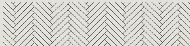
Parkett, das aus Elementen gleicher Abmessungen mit beidseitig rechtwinklig zugeschnitten Kopfseiten besteht, die rechtwinklig zueinander und im Winkel von 45° zu Wänden und/ oder Lagerbalken verlegt sind.
