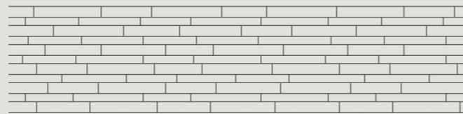
Parkett, das aus Elementen von unterschiedlicher, zufälliger Länge und einer Reihe von Breiten besteht, die parallel zueinander verlegt werden.
