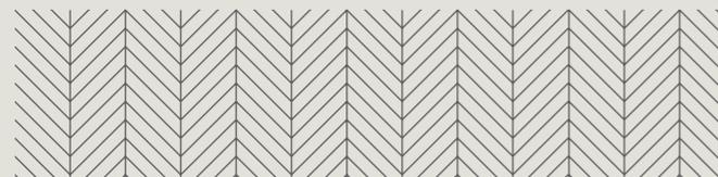
Parkett aus Elementen gleicher Abmessungen, deren Kopfseiten beidseitig zwischen 45° und 60° abgeschrägt sind. Sie werden Kopf gegen entweder im Winkel von 90° oder 120° zueinander verlegt, um parallele Motive zu bilden.
