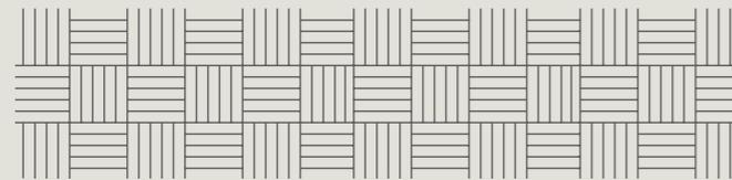
Zusammenstellung von Lamellen, Blöcken oder Leisten, die jeweils Kante an Kante positioniert werden und ein Quadrat bilden, dessen Seite gleich lang wie die Länge von Lamelle, Block oder Leiste ist.
